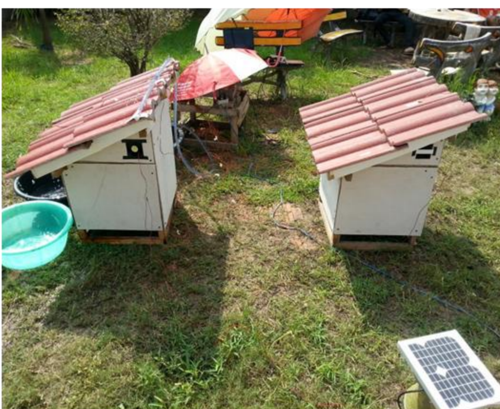
รูปที่ 4.3 บ้านทดลองที่ระบายความร้อนด้วยการพ่นน้ำกับการระบายความร้อนการพ่นน้ำที่อัตราการไหลเดียวกันร่วมกับการใช้พัดลมเซลล์แสงอาทิตย์
