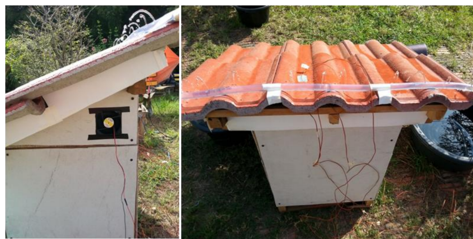
รูปที่ 4.2 บ้านทดลองที่ระบายความร้อนด้วยพัดลมเซลล์แสงอาทิตย์กับบ้านทดลองที่ระบายความร้อนด้วยการพ่นน้ำ
