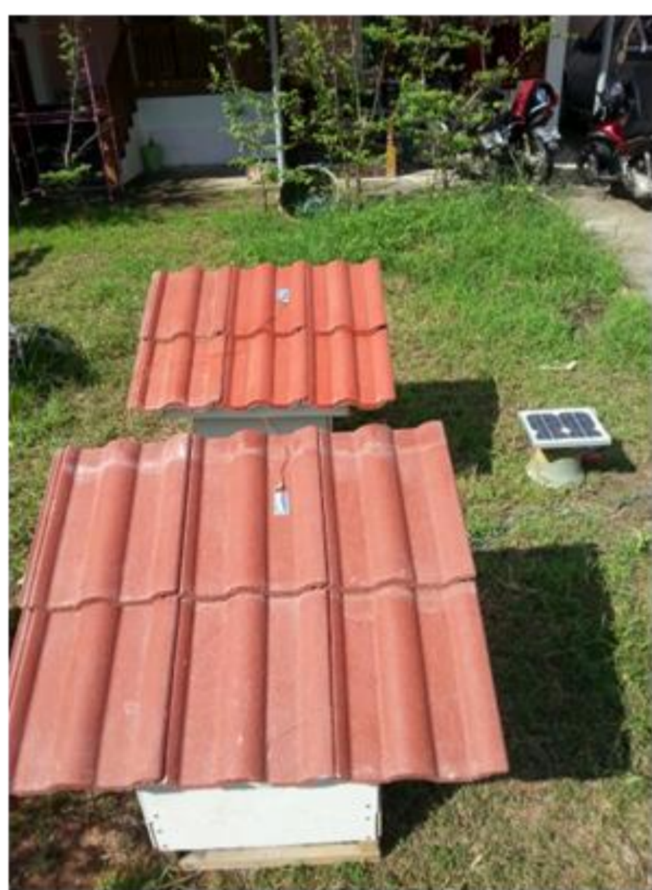
รูปที่ 3.1 บ้านทดลองที่ระบายความร้อนตามธรรมชาติกับบ้านทดลองที่ระบายความร้อนด้วยพัดลมเซลล์แสงอาทิตย์
